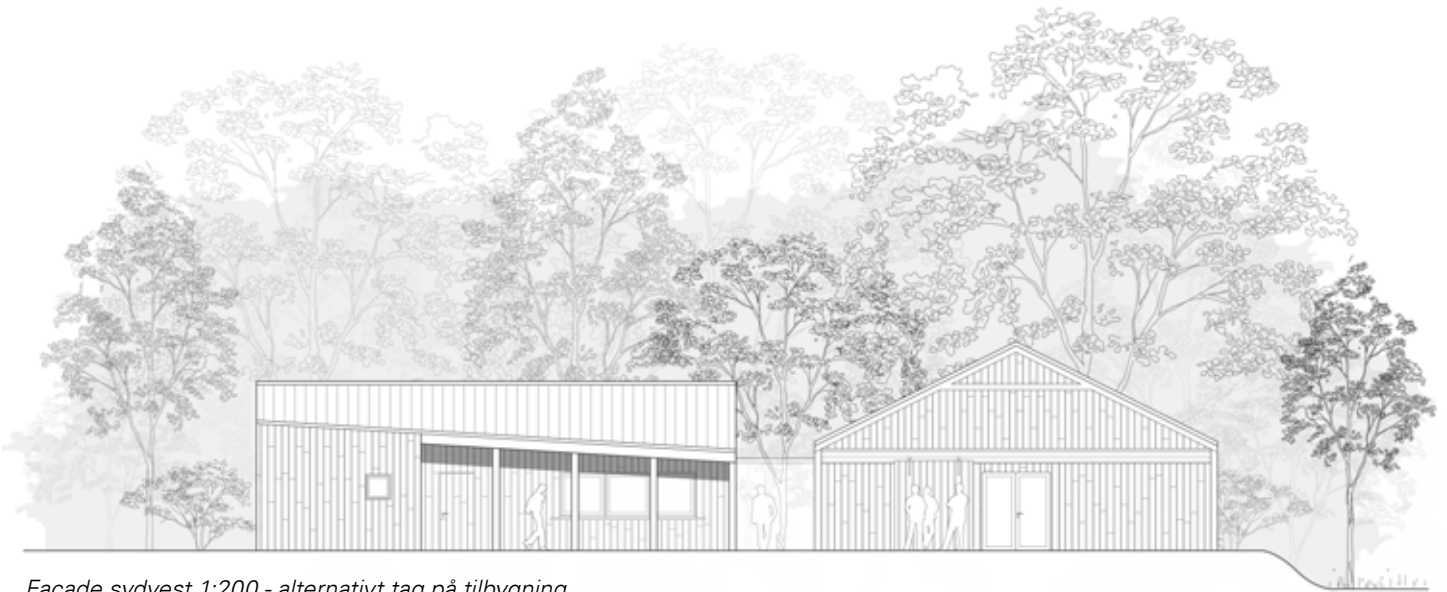
Facade sydvest 1:200 - alternativt tag på tilbygning
